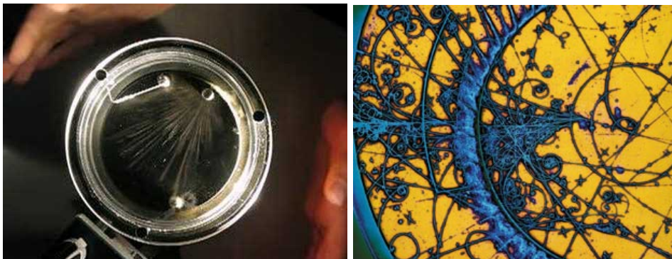
Figure 4: Links: Nebelkammer mit sichtbaren Teilchenspuren. Rechts: Aufgehübschte Blasenkammeraufnahme aus der Big European Bubble Chamber (Bild: CERN Courier). Durch ein in der Kammer herrschendes Magnetfeld werden die Spuren von geladenen Teilchen gekrümmt, so dass man auf die Ladung des Teilchens schließen kann.
